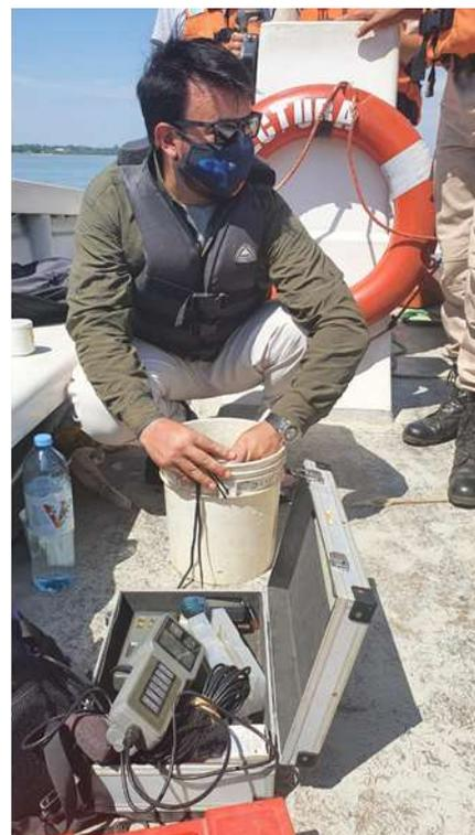
Toma de muestra del lecho rocoso y medición in situ de los parámetros de calidad de agua.
